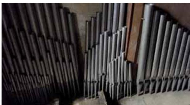
**1<sup>er</sup> phase** : relevage et restauration du sommier du Positif de Do, changement des 120 bourslettes, remplacement du ventilateur, nettoyage du buffet et dépoussiérage de la tuyauterie.
