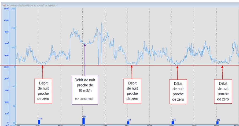
→ L'installation de ces équipements, l'analyse des données enregistrées et l'intervention rapide des équipes de Réseau 31 ont ainsi permis d'améliorer le rendement du réseau d'eau de la commune de Grenade :
