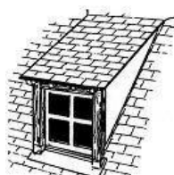
lucarne rampante ou en chien couché
